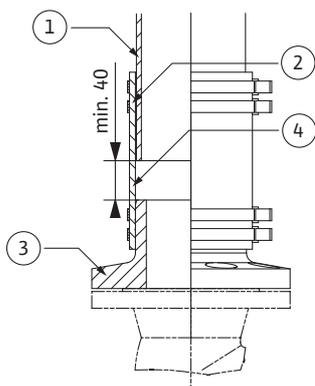
Чтобы избежать передачи сил и колебаний между установкой и напорным трубопроводом, соединение необходимо выполнять гибко. Для этого соблюдать расстояние между фланцевым переходником и напорным трубопроводом (рис. 5).
