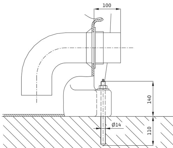
Посредством прилагающегося крепежного материала зафиксировать резервуар на полу (рис.. 3).
