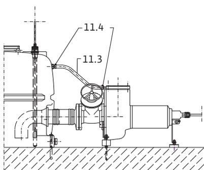
Посредством прилагающегося крепежного материала зафиксировать насосы на полу (рис.. 4).
